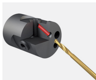
工位 3H, 刀具 2, 转塔钻斜孔
