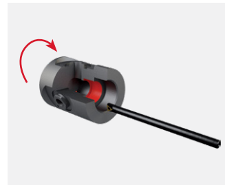
工位 9H, 刀具 4, 转塔 内轮廓车削
