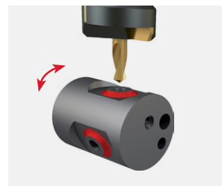
工位 4V, 刀具 1, 转塔沟槽车削
