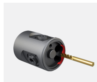
工位 6H, 刀具 1, 转塔凹槽铣削
