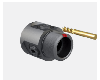
工位 11H, 刀具 1, 转塔 沟槽铣削
