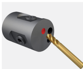
工位 3H, 刀具 1, 转塔斜面铣削
