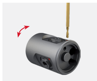
工位 6V, 刀具 2, 转塔横向钻孔
