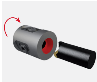
工位 9H, 刀具 2, 转塔 扩孔
