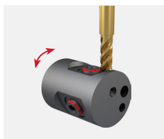
工位 4V, 刀具 2, 转塔六边铣削
