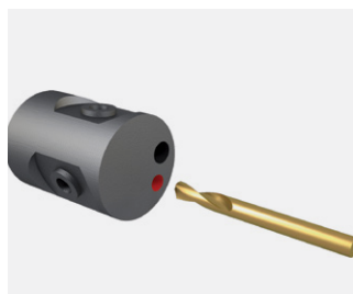
工位 2H, 刀具 2, 转塔预钻孔
